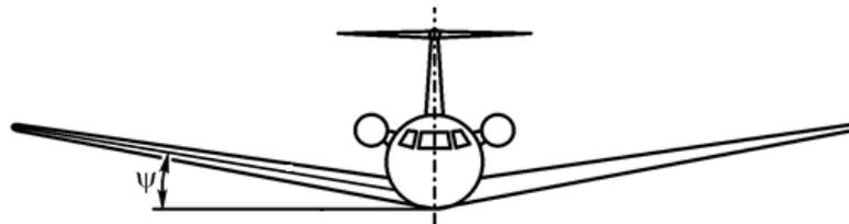
Рис. 22. Положительный угол поперечного  $V$  крыла
