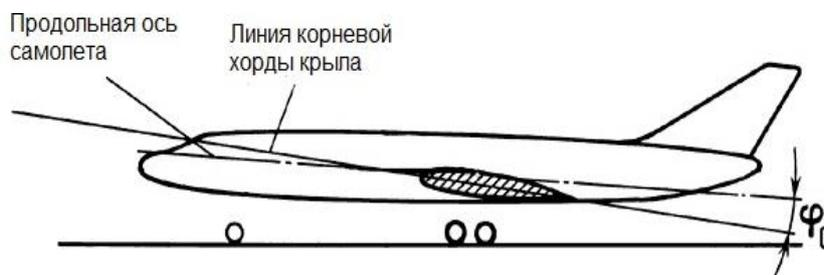
Рис. 44. Угол установки крыла
