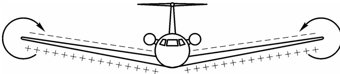
Рис. 30. Перетекание воздуха через законцовки крыла.
