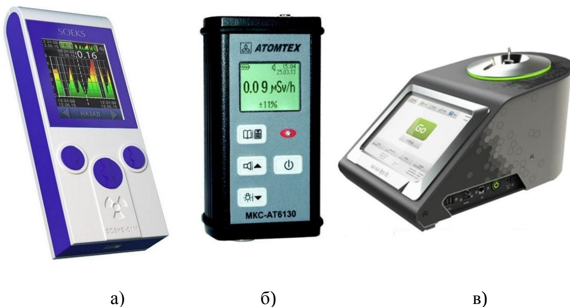
Рисунок 8 – Приборы и средства, используемые для измерения или контроля ионизирующих излучений: а) дозиметр СОЭКС 01М Прайм; б) радиометр МКС-АТ6130; в) спектрометр NMReady-60PRO.
