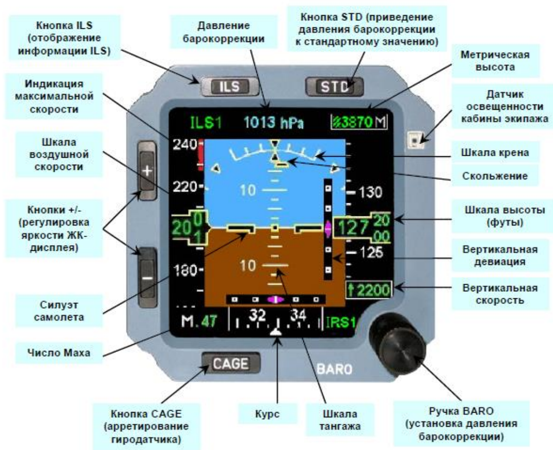
Рисунок 25 - Органы управления и индикация Интегрированного электронного резервного прибора
