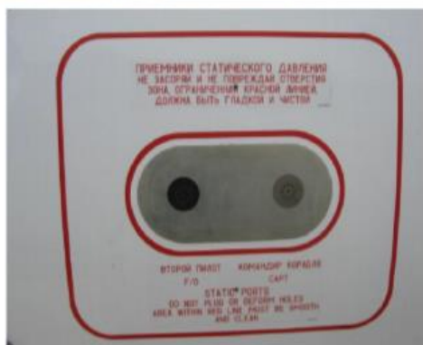
Рисунок 14- Приемники статического давления на самолете
