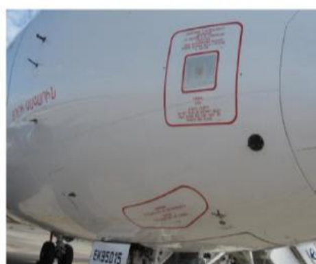
Рисунок 14- Приемники статического давления на самолете
