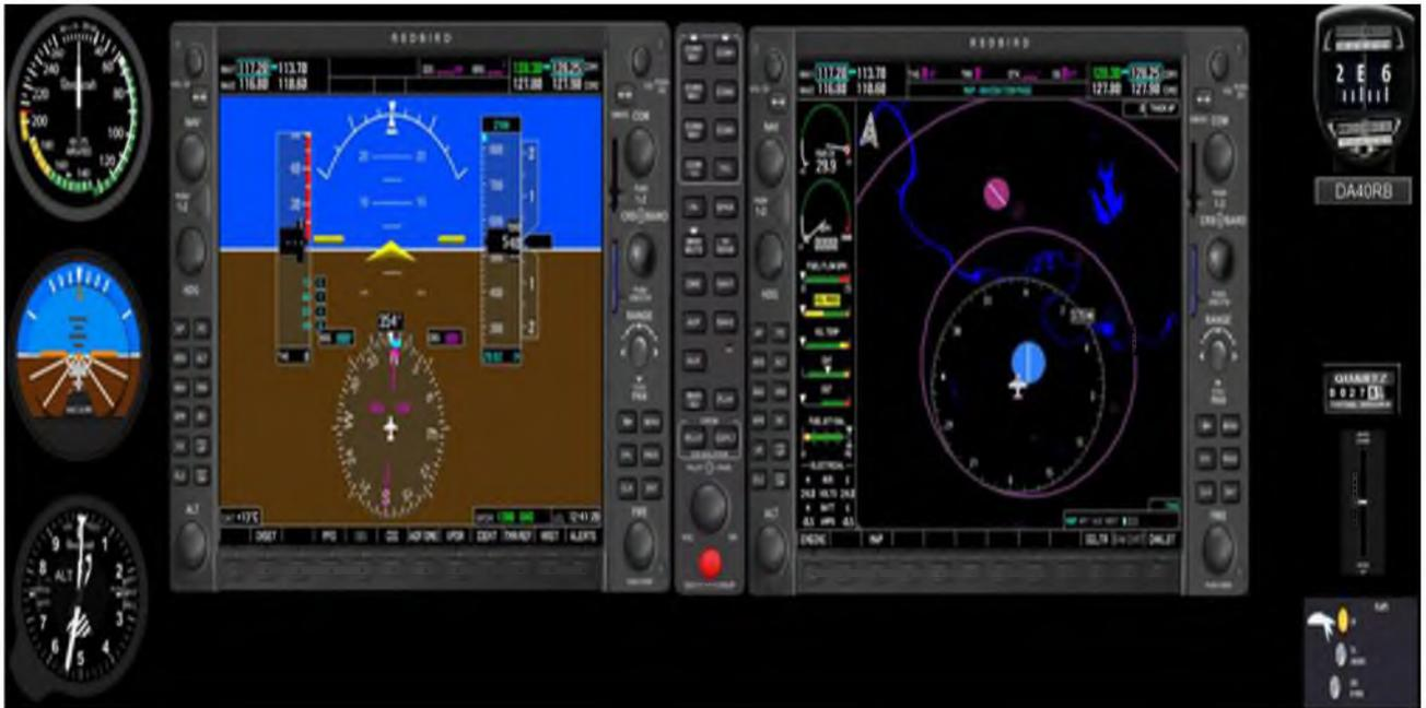
Рисунок 9 – Интегрированная система управления полетом Garmin G1000
